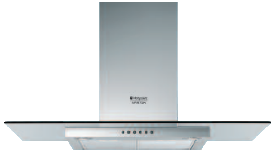
Diamond HD 90 T IX/HA NOU • Hotă aspirantă de 90 cm. • 1 motor cu capacitate de aspirare max 616 m³/h (cu funcția Booster 703 m³/h) • Comenzi Soft Touch • Lumină: 2 lămpi cu halogen de 20 W • Timer Clean Air automat • 3 viteze cu funcție Booster • 2 filtre din aluminiu detașabile Inox – IX
